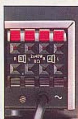
TESLA AZS 224 je stereofonní zesilovač určený pro kvalitní reprodukci zvuku v bytových podmínkách. Svou koncepcí a dosahovanými parametry vyhovuje jako základní článek elektroakustického řetězce pro všechny modulační zdroje včetně CD přehrávače. Zesilovač umožňuje připojení pěti zdrojů stereofonního signálů: gramofonu, tuneru, dvou magnetofonů, CD přehrávače. K zesilovači lze připojit dva páry reproduktorových soustav.
